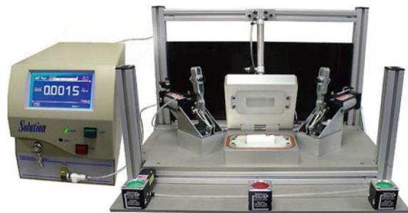
固体药品电磁感应密封药瓶无损检测
