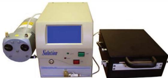
配备封闭夹具的TME Solution设备，真空泵装在一侧
