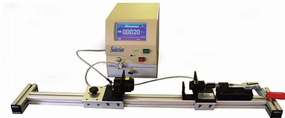
冲洗刀片组件泄漏检测夹具
