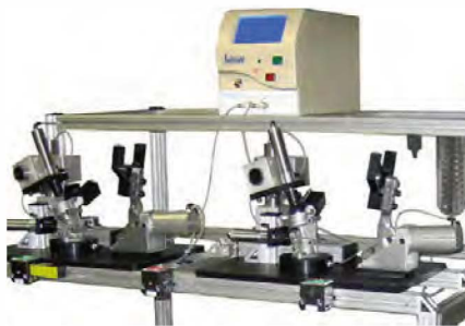
使用TME Solution检测仪和定制夹具检测EGR阀门
