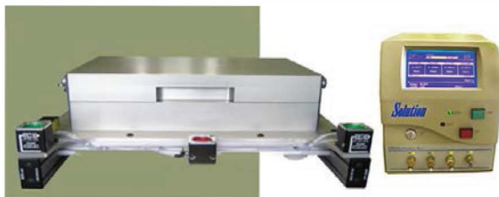
定制夹具旨在使用TME解决方案 仪器测试汽车反光镜
