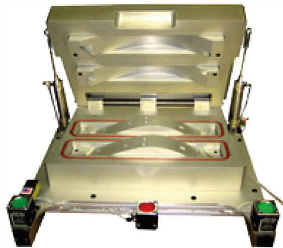
定制夹具旨在测试汽车反光镜是否泄漏
