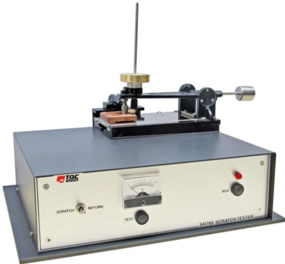
该仪器配备一个机盖，罩着齿轮和其它部件，用于以恒定速度（每秒 3-4cm）操作滑块和测试臂提升机构。测试针的支撑臂受力平衡且为刚性结构，可以防止在球面测试区域抽动或颤动。
